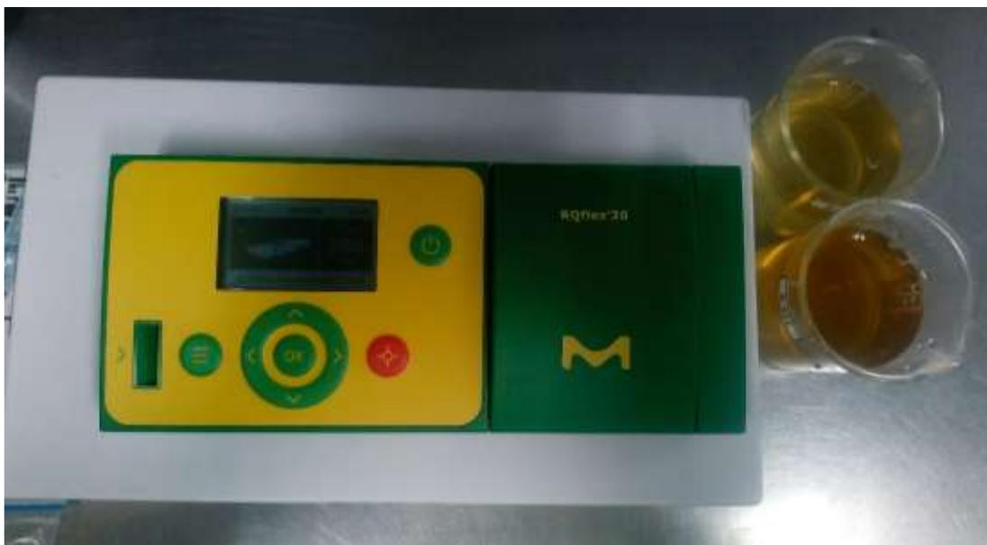
*Figura 8. Equipo RQflex20 corriendo muestras diluidas antes preparadas.*
