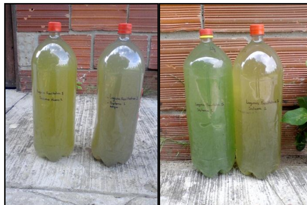
Fotografía 19. Muestras Efluentes lagunas facultativas sistema antiguo y sistema nuevo.
