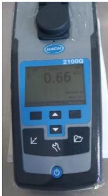
**Imagen 14.** Turbidímetro HACH 2100Q.
