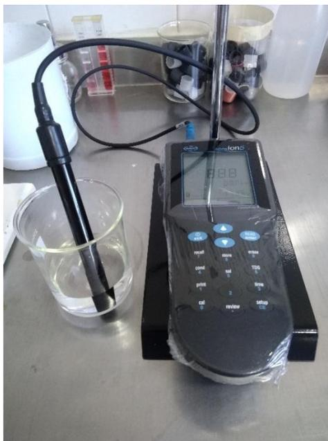
**Imagen 12.** Medidor portátil de conductividad HACH Sension5.
