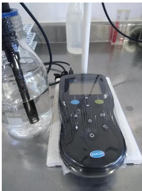
**Imagen 11.** Medidor portátil de pH HACH HQ11D.
