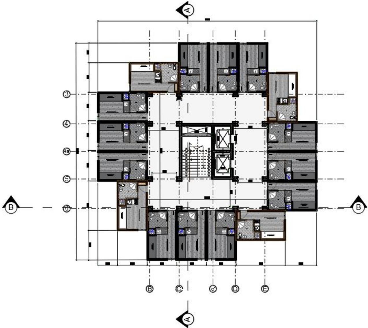
Ilustración 38 Planta de distribución arquitectónica pisos 4,6,8,10
