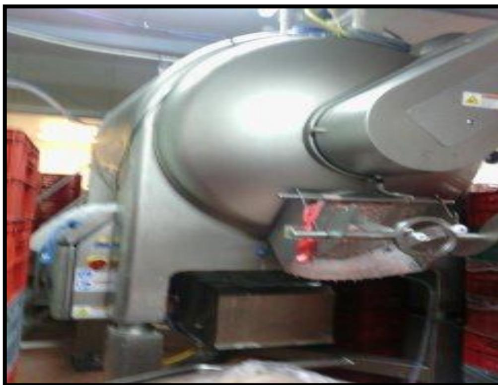
**Figura 3.** Tumbler (masajeador) Polar capacidad 3000 Kg.
