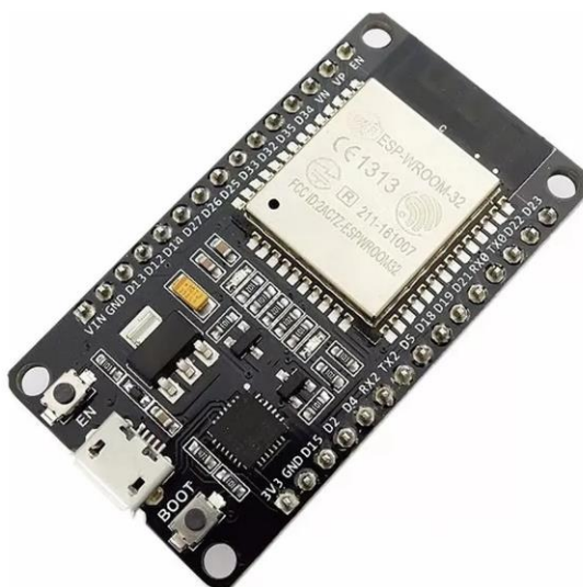
Ilustración 73. Tarjeta ESP32 WIFI
