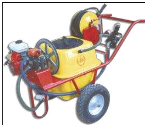
Ilustración 12. Aspersora con motor de tiro simple arrastre/ (Anónimo, S.f.)
