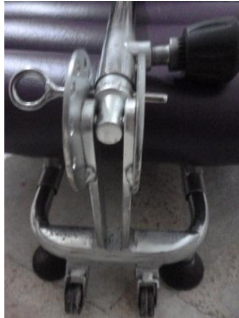
Figura 56. Eje de unión realizada en torno
