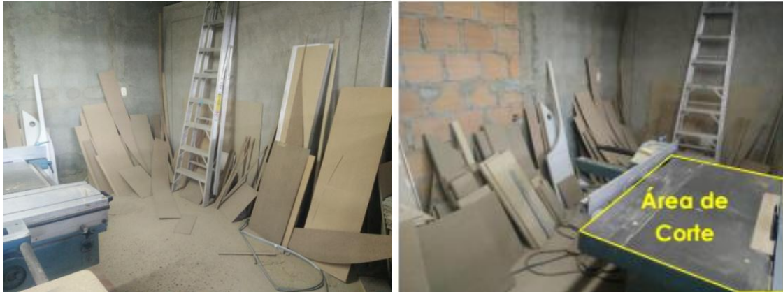
Ilustración 45 Retal de láminas que van desde 9mm hasta 25 mm de grosor. (Lugar área de corte)
