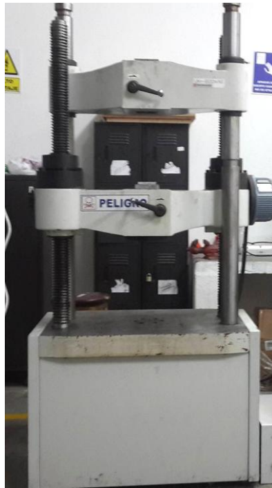
Ilustración 39. Máquina Universal, ensayo de tracción
