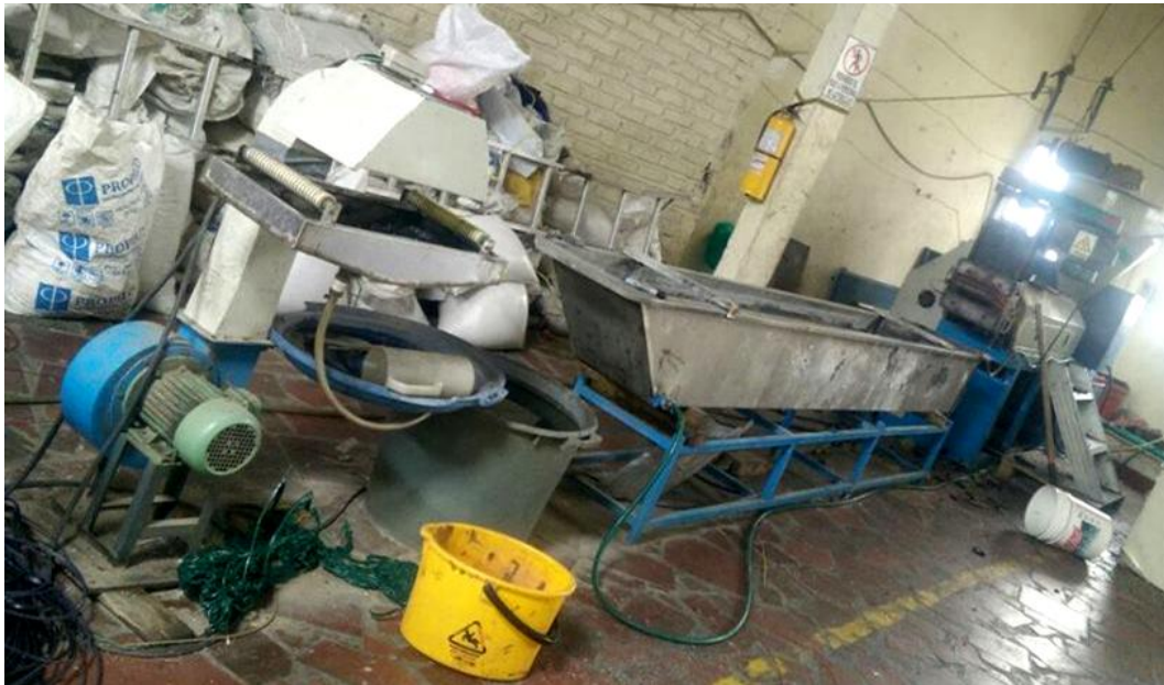
Ilustración 4. Proceso de extrusión, maquina extrusora de monofilamentos
