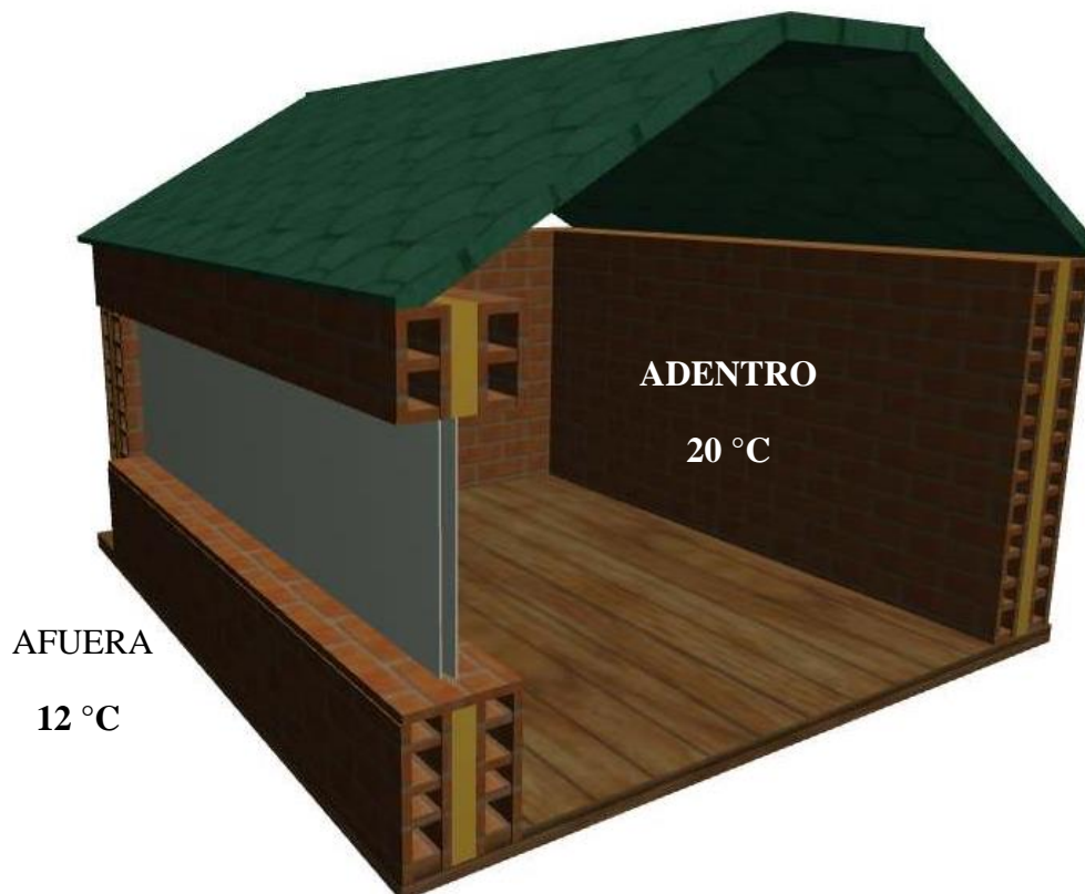
Ilustración 51: Muro aislado con doble vidrio.
