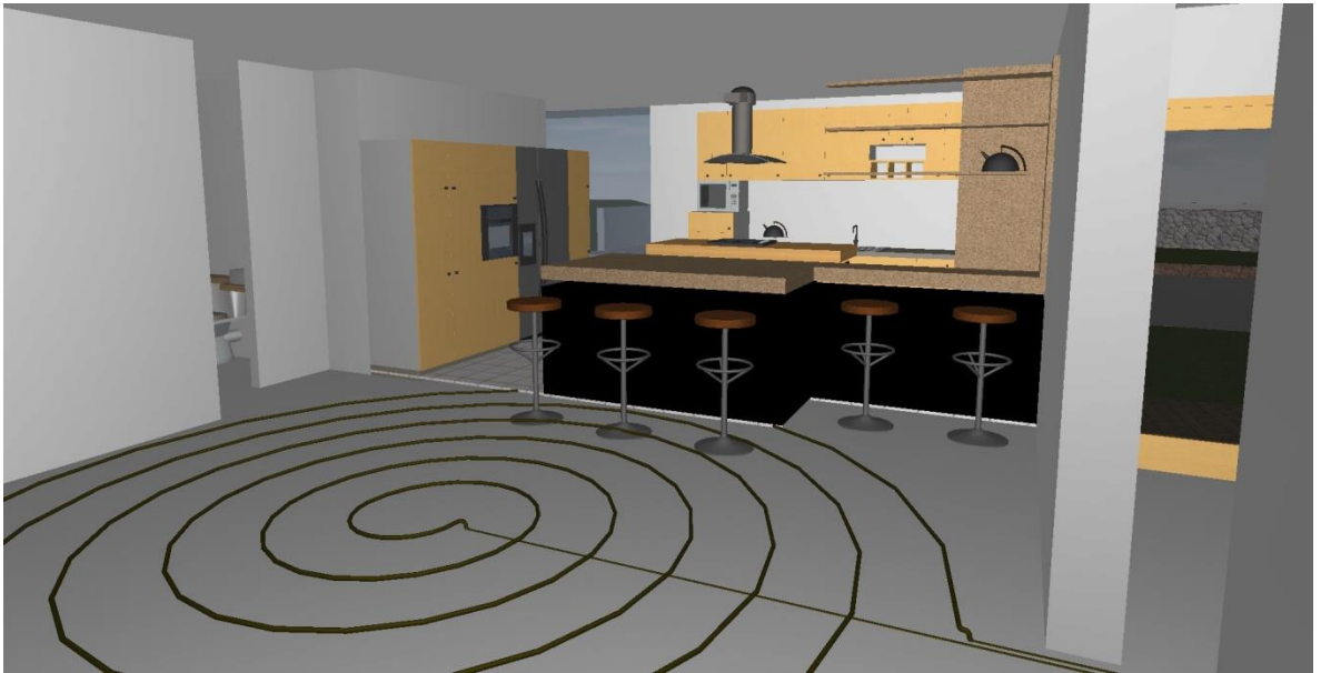
Calefacción a través de piso radiante en tubería de cobre.
