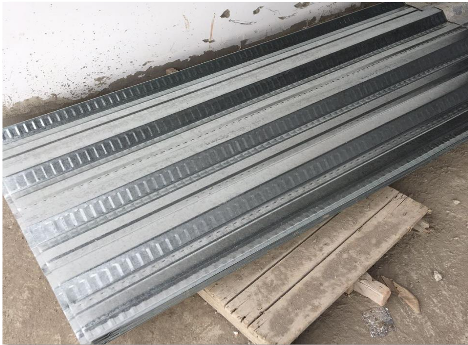
Figura 51. Lámina metal deck usada en la losa de entrepiso
