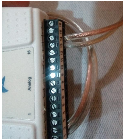
Fig. 53 Canales analógicos utilizados de la NI USB 6009 para envío y recepción de datos de la máquina síncrona..
