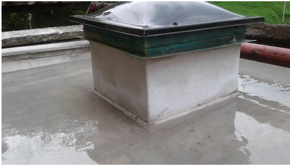
Imagen 33 Prueba de inundación de placa. Fuente: autor
