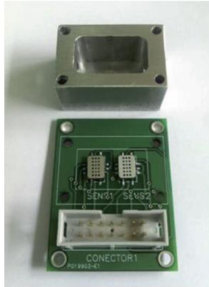
Figura 5. Montaje en placa de dos sensores de gases SGX Sensortech MiCS-5524 (Fernández-Muñoz et al., 2017)
