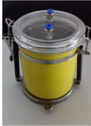
Figura 33. Cámara de concentración de gases.
