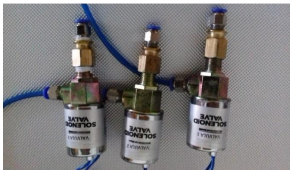
Figura 42. Válvulas solenoides normalmente cerradas (Fuente autor).
