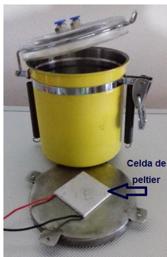
Figura 34. Celda de Peltier como elemento de generación de calor para calentar las muestras de cacao
