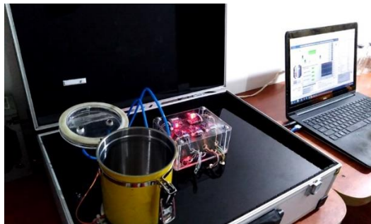
Figura 64. Cámara de concentración de volátiles abierta (Fuente autor).
