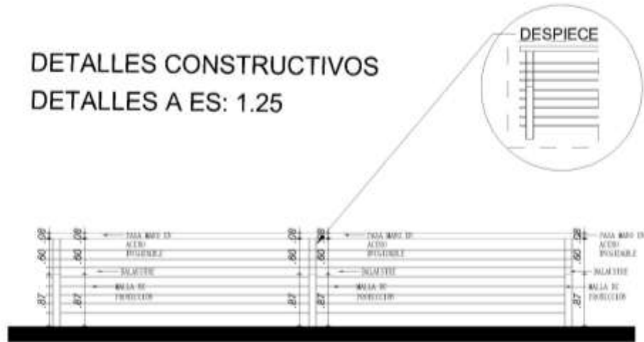
DETALLE DE BARRA PORTUARIA DETALLES A ES: 1.25
