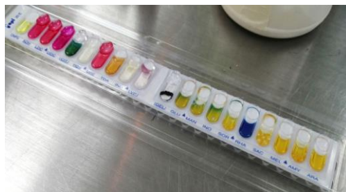
Figura 3. Sistema de pruebas Bioquímicas API
