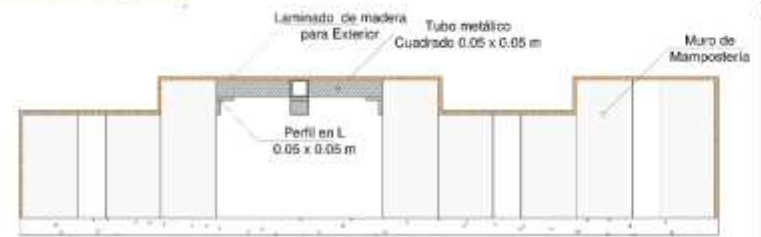
Corte Longitudinal del Mobiliario
