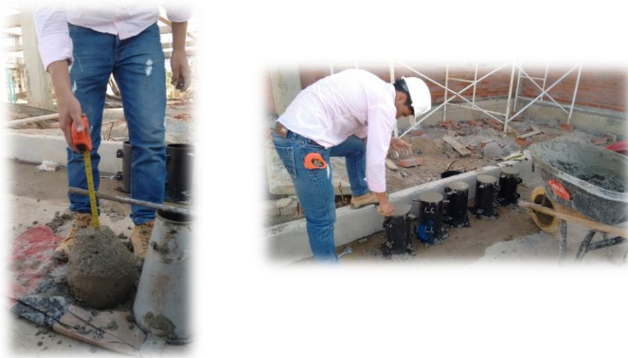
Figura 27. Ensayos de resistencia a la compresión del concreto
