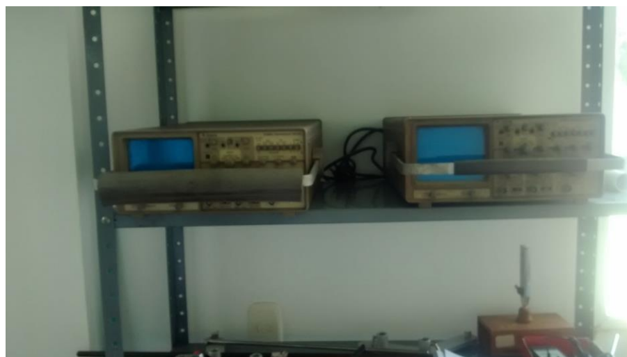
Figura 3. Osciloscopios para observación y medida de los parámetros de tensión y frecuencia de los motores conectados. Fuente: El Autor
