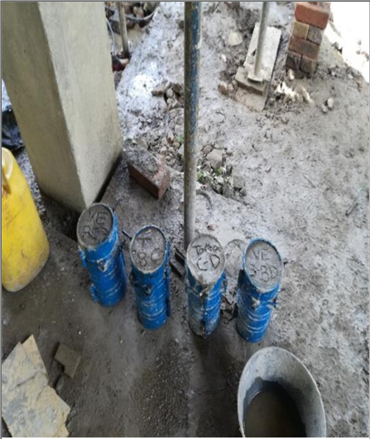
Figura 7. Muestras de concreto
