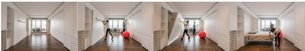
Imagen 1. Sistema de muros plegables
