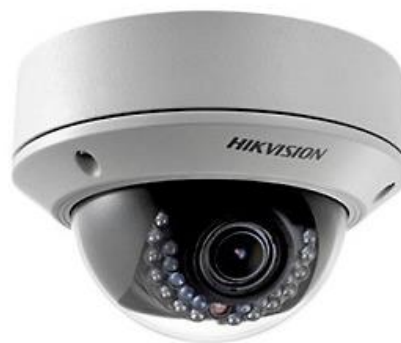
Ilustración 18 - Cámara tipo domo hikvisión para exteriores 9
