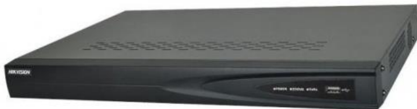
Ilustración 20 - NVR Hikvision de 8 canales con capacidad para dos discos duros 11
