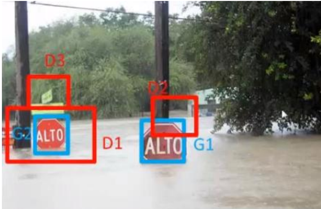
Figura 90. Imagen con el recuadro de entrenamiento y el recuadro de detección
