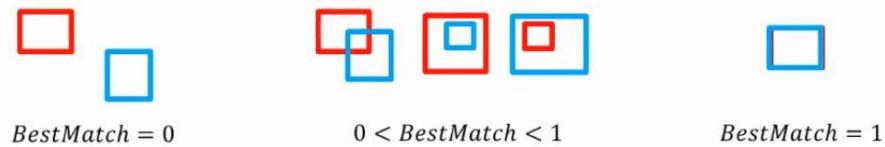
Figura 91. Intervalos de medición para la evaluación de los detectores
