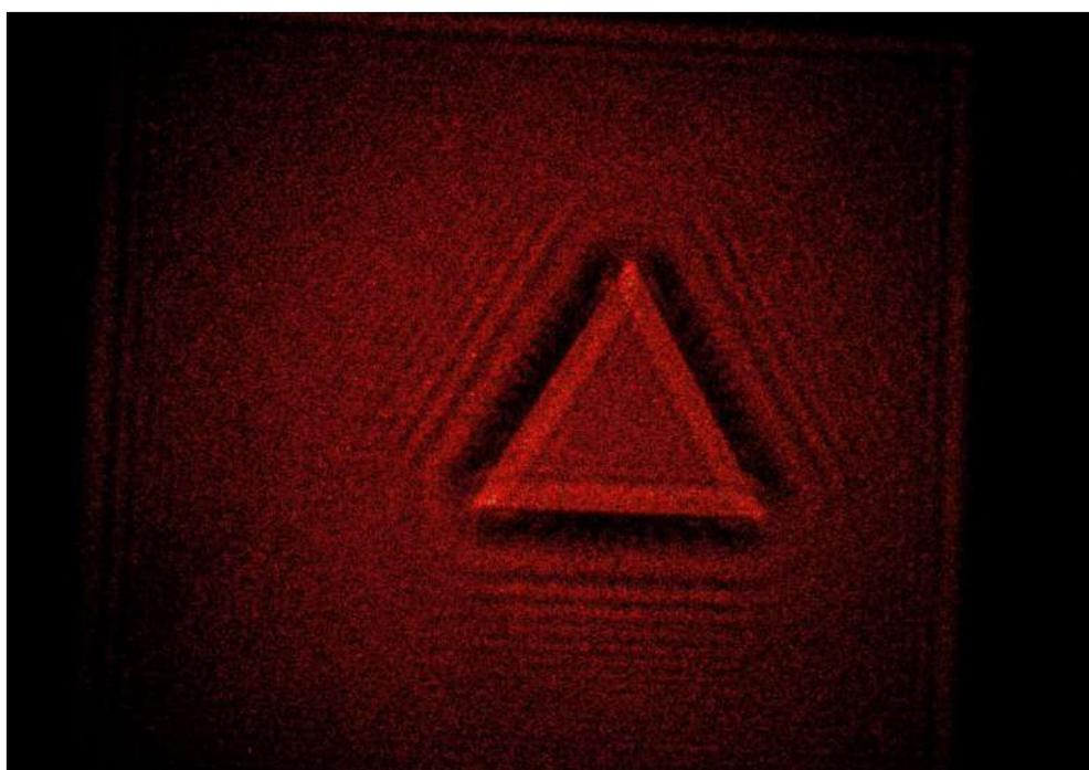
**Figura 6.9:** Reconstrucción óptica del holograma de la figura 6.8a sobre el difusor
