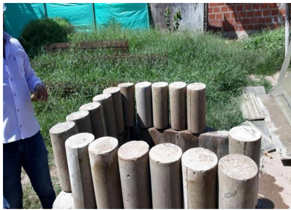
Ilustración 36 Cilindro para prueba de rotura
