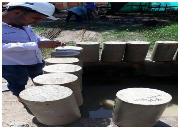
Ilustración 35 Cilindros para prueba de rotura
