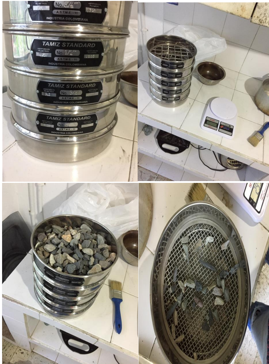
Ilustración 84. Ensayos de Granulometría basados en la NTC 174. Fuente. Autor
