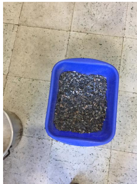
Ilustración 85. Ensayos de porcentaje de humedad. Fuente. Autor
