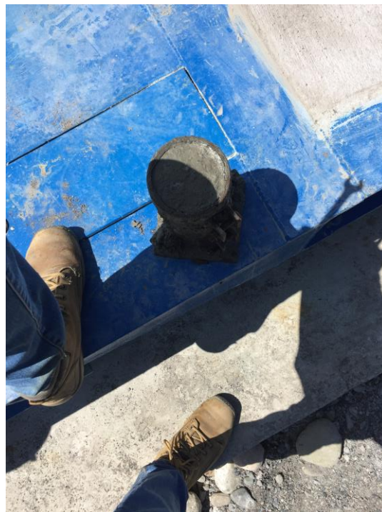
Ilustración 82. Cilindro de concreto 3714 PSI. Fuente. Autor
