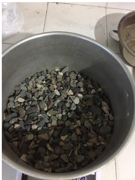
Ilustración 85. Ensayos de porcentaje de humedad. Fuente. Autor
