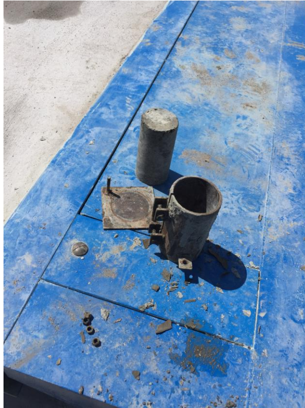
Ilustración 83. Cilindro y muestra de concreto 3714 PSI. Fuente. Autor
