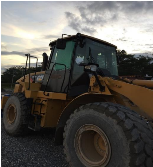
Ilustración 18. Cargador 950H sellado con plástico para evitar daños por humedad, esperando ser reparado por pérdida del vidrio lateral derecho (Autor)
