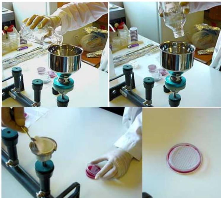
Figura 2. Procedimiento de la técnica de filtración por membrana.
