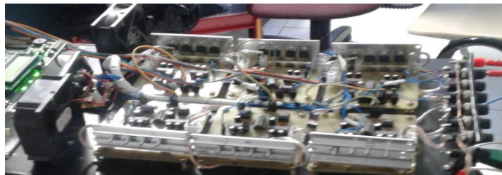
Figura 3.17. Arreglo de ventiladores para aumentar la refrigeración de los Mosfets
