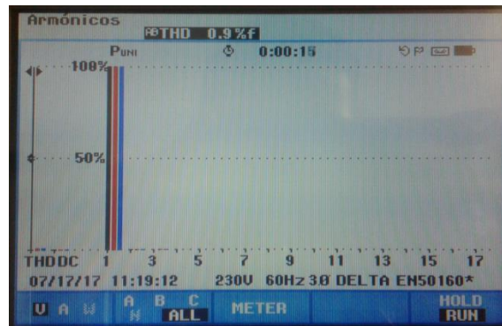
Figura 7.31. Espectro armónico de las tensiones de línea.
