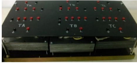
Figura 3.11. Fotografía del banco de transformadores con los bornes de conexión.
