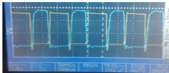
Figura 3.6. Formas de onda del control S1A y S2A en el osciloscopio.
