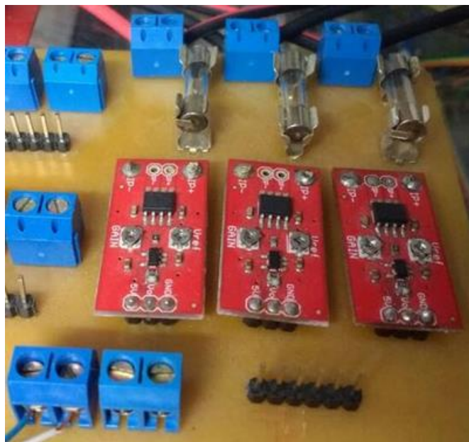
Figura 4.4. Sistema de medición de corriente.
