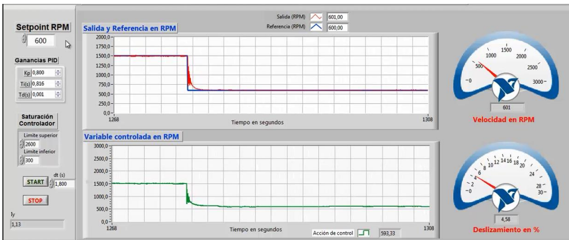
Figura 7.34. Respuesta del sistema ante un cambio en descenso.
