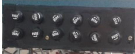
Figura 3.12. Tarjeta de protecciones contra cortocircuito.
