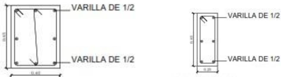
Ilustración 75. Detalle Viga y vigueta de entrepiso.
