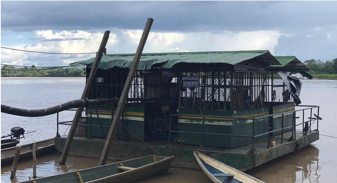
*Ilustración 9 Barcaza utilizada para la Captación Flotante*
