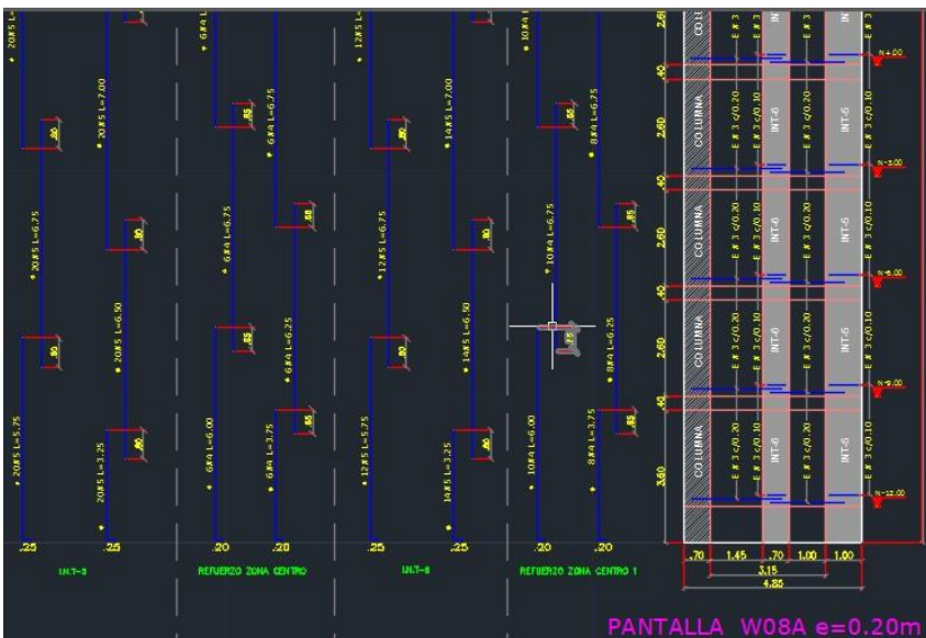
Imagen 6. Plano estructural de pantallas
