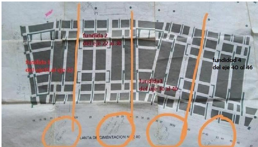
Imagen 29. Etapas de vaciado de concreto de cimentación
