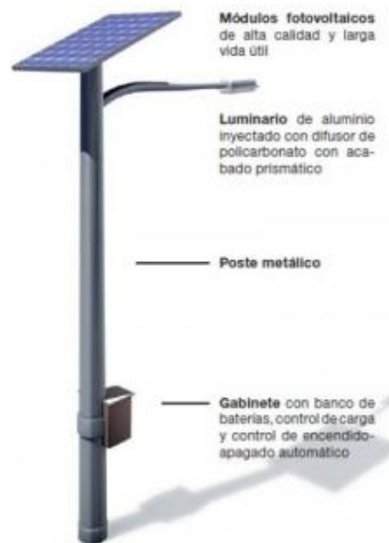
Ilustración 34. Esquema funcional de luminaria con panel solar
