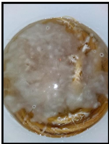
Ilustración 24 lavado en 10 L de agua y NaOH 5% p/v
