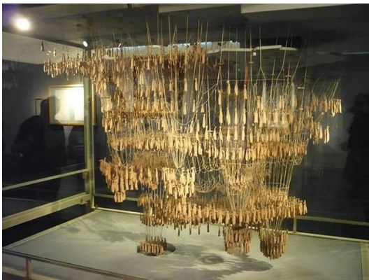
Ilustración 3: Modelo de fuerzas por Gaudí y Curva catenaria Fuente:
