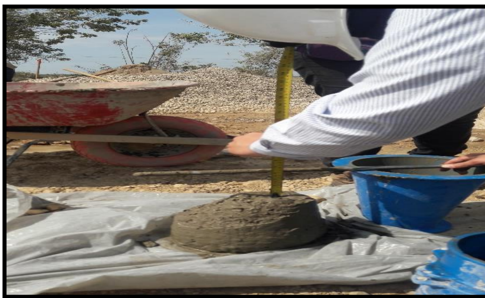
Figura 31. Medición Asentamiento De La Mezcla.
