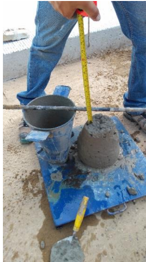
Ilustración 27 Medida asentamiento concreto
