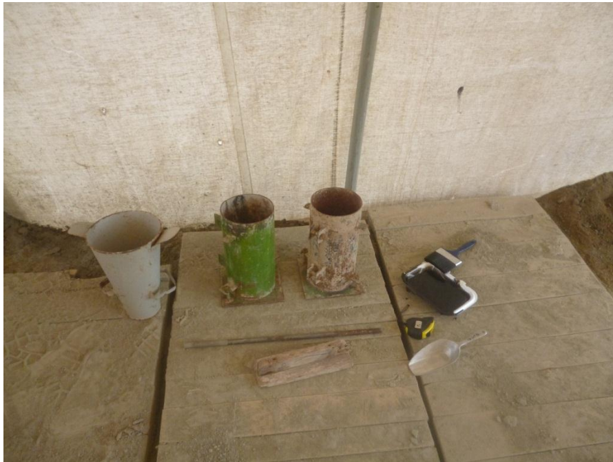
Figura 17. Elementos para ensayo de slump.
