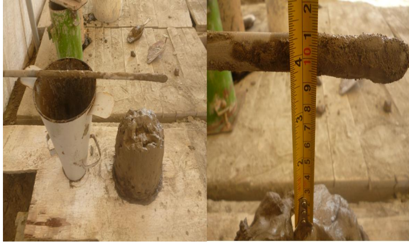
Figura 18. Medición de asentamiento.
