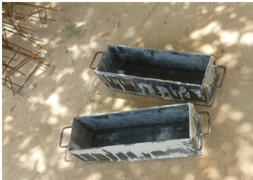
Figura 24. Formaleta de vigas para ensayo.
