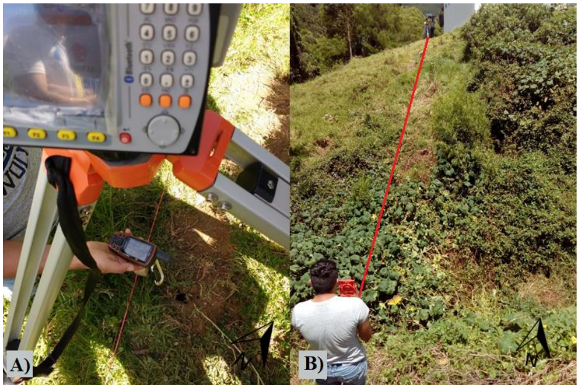
FIGURA 4: levantamiento topográfico. A) Georreferenciación de la Estación Total GEOMAX zoom 30 pro con el GPS MAP 64s Garmin. B) Levantamiento topográfico de la línea de estudio N°3. Fuente: Autores
