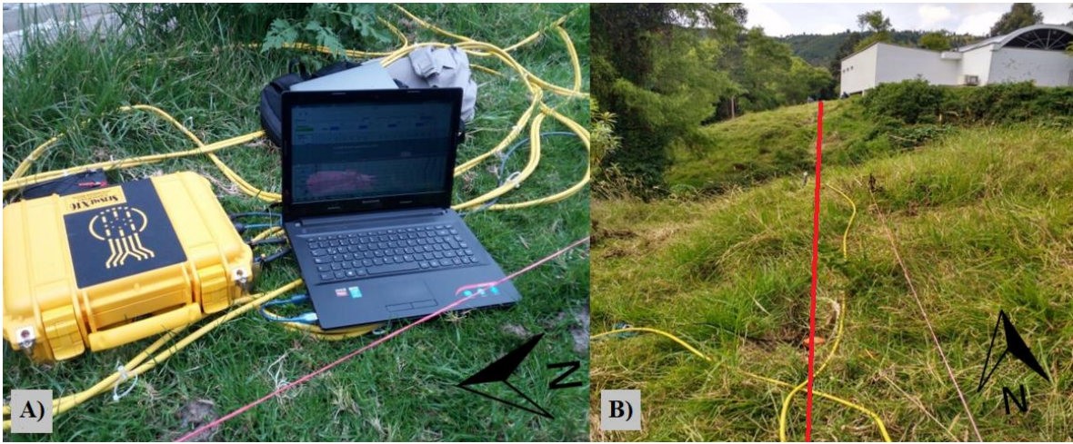
FIGURA 6: Adquisición de datos refracción sísmica. A) Sismógrafo conectado a un ordenador para la adquisición de los datos. B) Tendido de adquisición de Refracción sísmica. Fuente: Autor.
