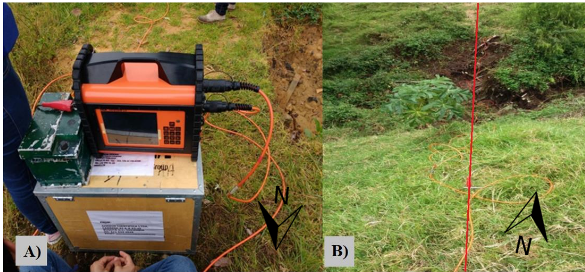
FIGURA 16: Adquisición de datos de métodos de geoelectrica. A) Equipo de adquisición de datos Terrameter LS (ABEM, 2012). B) Tendido de la línea con separación de electrodos de 2.6m. Fuente: Autores.
