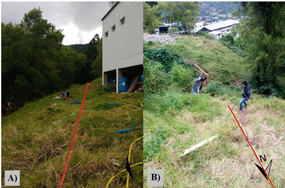
FIGURA 11: Adquisición de datos MASW. A) Tendido de adquisición de MASW. B) Disparos generados con maso de 16 lb. Fuente: Autor.
