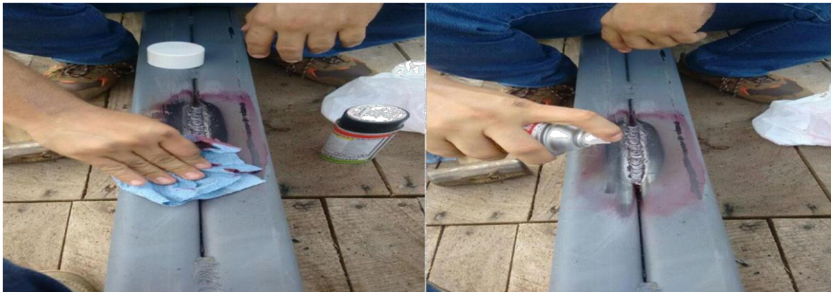
Imagen 36. Prueba de tinta de los perlines Fuente: Autor
