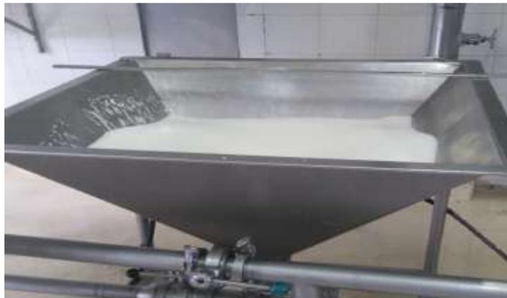
**Figura 11.** Embudo para la adición de insumos
