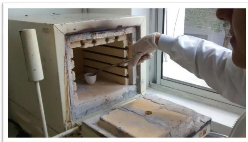
**FIGURA 4.** Prueba de ceniza para el pan bola de leche en el laboratorio control y gestión ambiental CGA S.A.S foto tomada el día 21/11/16 por Paola Latorre.
