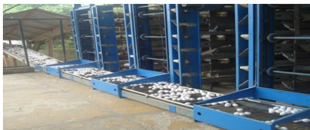
Figura 3: Transporte de huevos por bandas.
