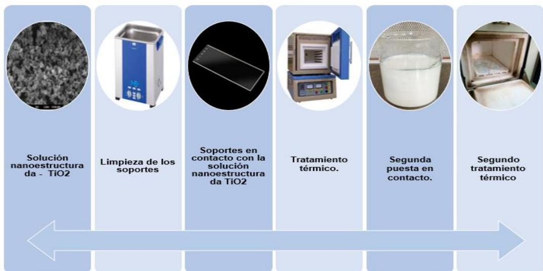
**Figura 9.** Diagrama general de la metodología empleada para la preparación de los soportes recubiertos con películas de nano TiO<sub>2</sub>.
