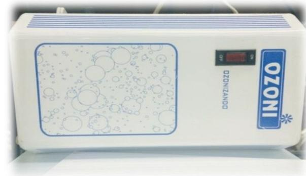
**Figura 8.** Ozonizador adaptado al sistema fotocatalítico.
