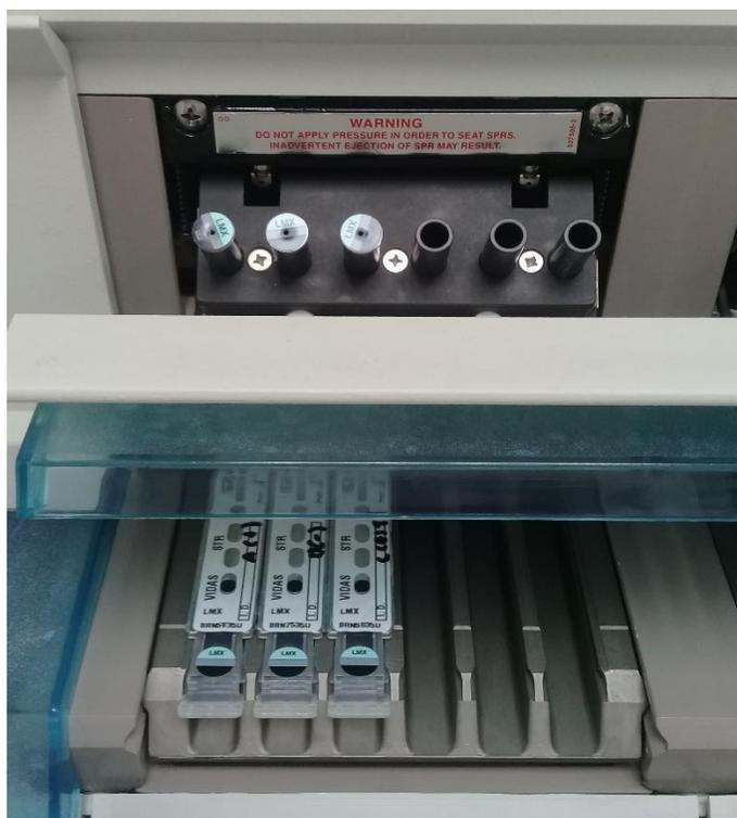
Imagen 38. Control de calidad VIDAS-LMX. Montaje en el equipo VIDAS para iniciar el análisis. De izquierda a derecha, Control positivo: *L. monocytogenes* ATCC 13932, Control negativo: *E. coli* ATCC 25922 y prueba de esterilidad.
