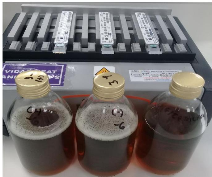
Imagen 37. Control de calidad VIDAS-LMX calentamiento a 131°C durante 5 minutos en heat and go. De izquierda a derecha, Control positivo: *L. monocytogenes* ATCC 13932, Control negativo: *E. coli* ATCC 25922 y Prueba de esterilidad.
