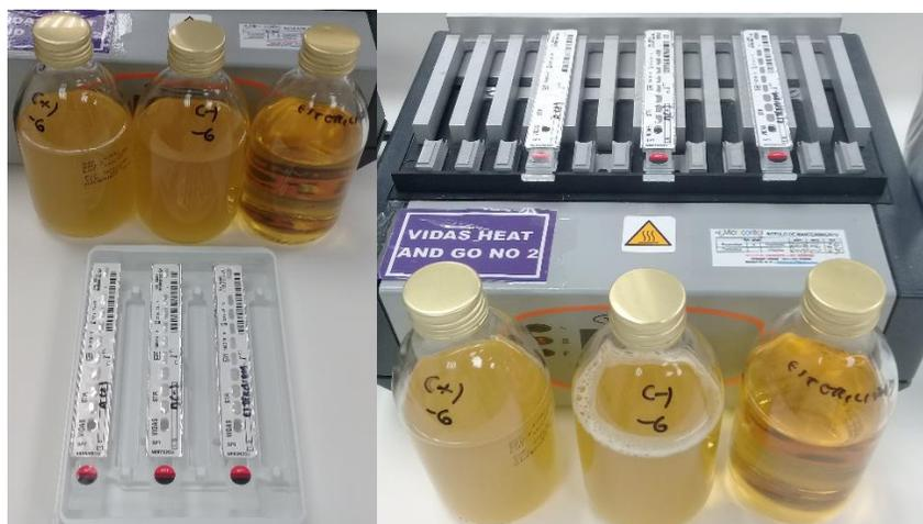
Imagen 41. Control de calidad VIDAS-SPT calentamiento a 131°C durante 5 minutos en heat and go. De izquierda a derecha, Control positivo: *S. typhimurium* ATCC 14028, Control negativo: *E. coli* ATCC 25922 y test de esterilidad.
