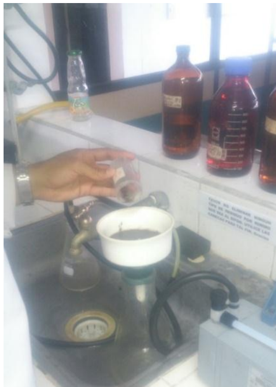
Figura 13. Filtrado de la muestra con acetato de amonio a bomba de vacío
