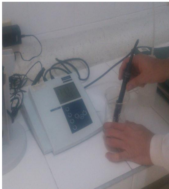
Figura 18. Determinación de la conductividad eléctrica
