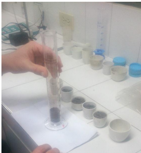
Figura 6. Determinación de la densidad aparente
