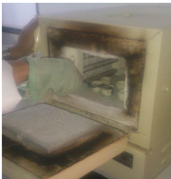
Figura 16. Ignición de la materia orgánica en mufla de 500°C
