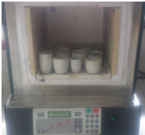
Figura 15. Muestras secadas en mufla de 105°C
