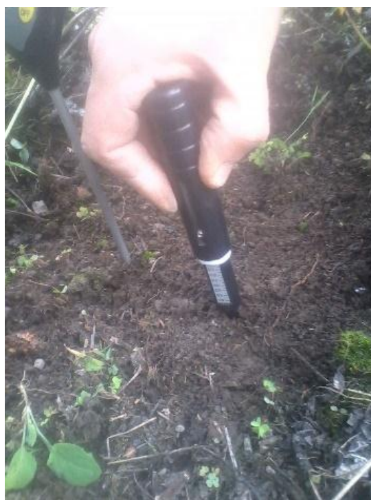
Figura 10. Toma de la resistencia mecánica con el penetrometro de mano cual se introdujo en tres puntos diferentes del suelo alrededor del árbol.
