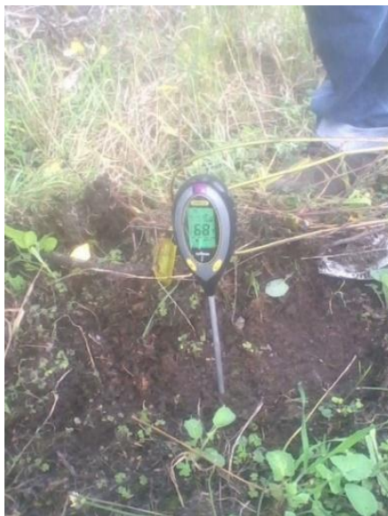
Figura 11. Toma de la temperatura del suelo con el Multiparametro
