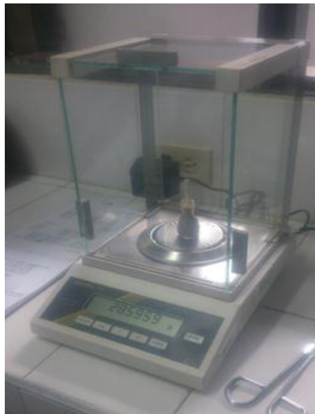
Figura 8. Pesado del conjunto picnómetro-suelo
