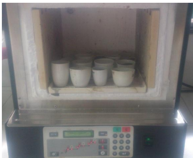
Figura 9. Secado de las muestras de suelo en mufla
