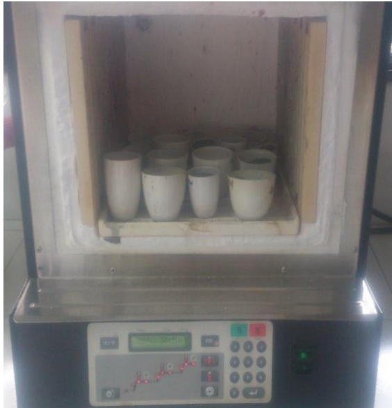
Figura 5. Secado del suelo en la mufla a 105°C
