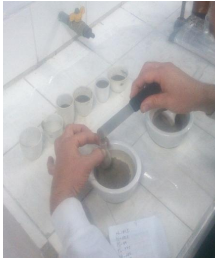
Figura 7. Macerado de la muestra de suelo y llenado del picnómetro
