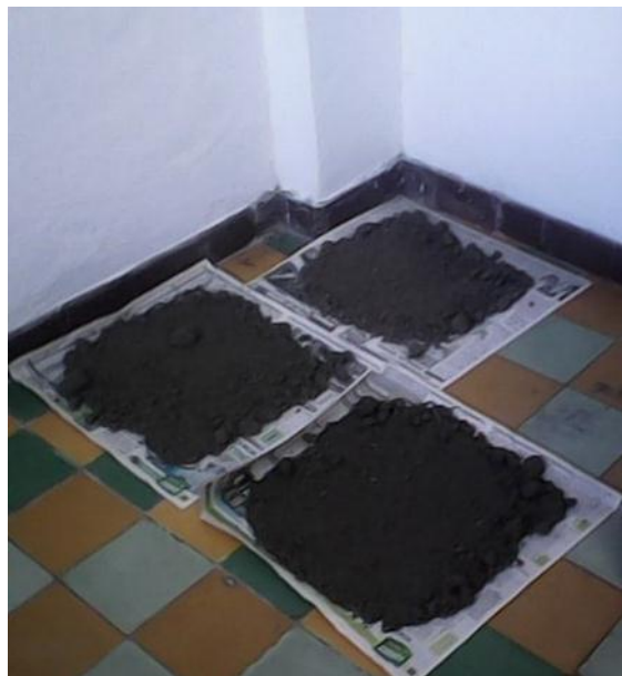
Figura 4. Secado de las muestras de suelo al aire
