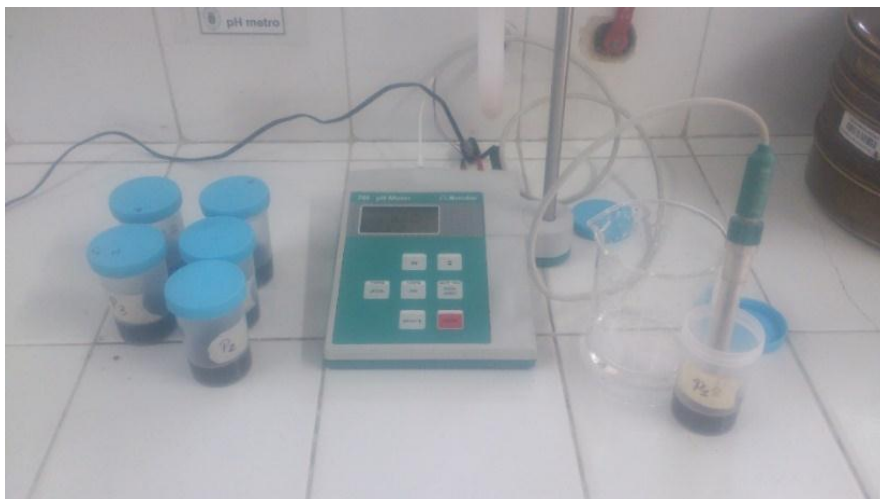
Figura 12. Determinación del pH del suelo con el potenciómetro
