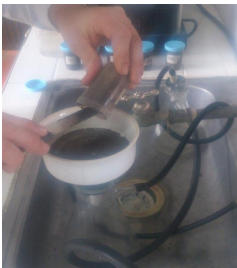
Figura 17. Filtrado de la muestra con agua destilada
