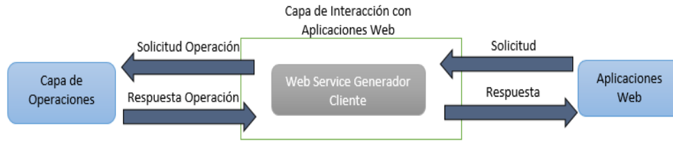
Figura 8. Componentes e interacciones de la capa de Interacción de aplicaciones Web.
