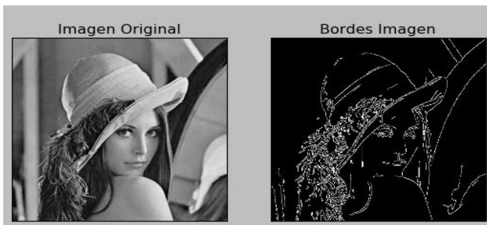
Figura 22. Bordes de una imagen utilizando el método canny.
