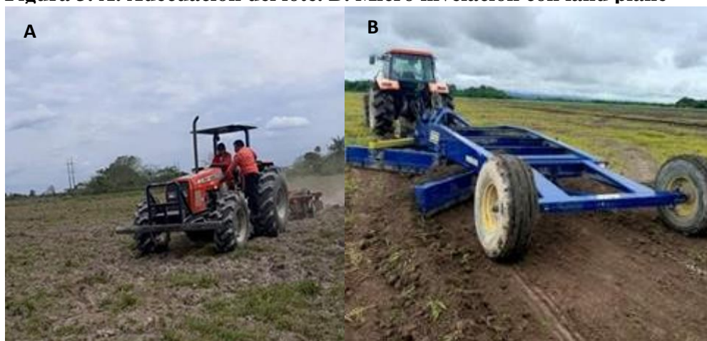
Figura 3. A. Adecuación del lote. B. Micro nivelación con land plane
