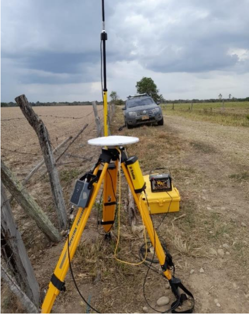
Estación satelital para el levantamiento topografico
